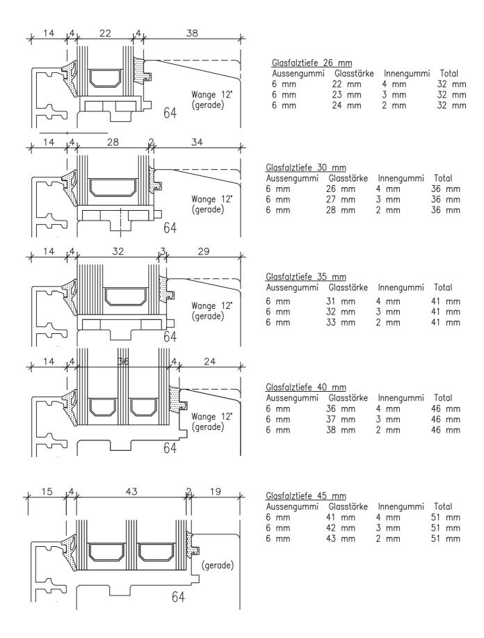
2. Gummidichtung im Flügelüberschlag
